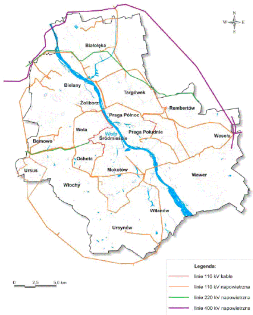
Rysunek 20. Rozkład linii elektroenergetycznych w Warszawie
