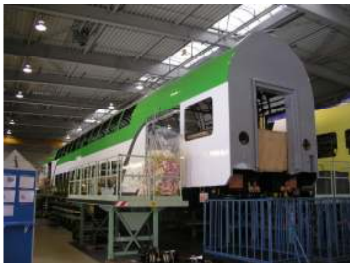
Montaż wagonu pociągu push-pull w barwach Kolei Mazowieckich
